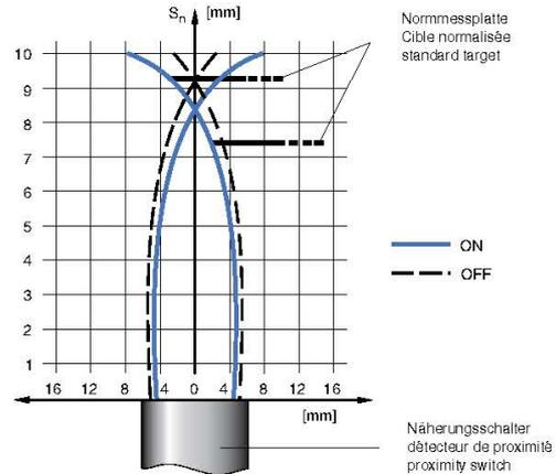
**Einbau / Montage / Installation ( $\Delta s < 10\% s_p$ ):**
